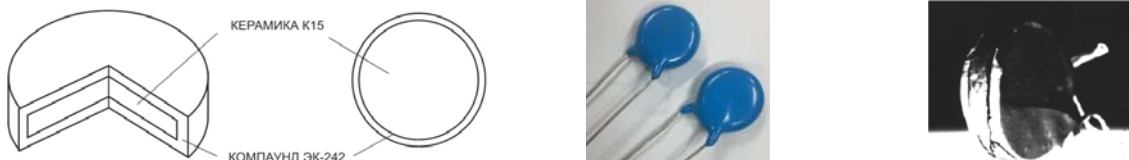
Рис. 1. Дисковий конденсатор і руйнування його кераміки
