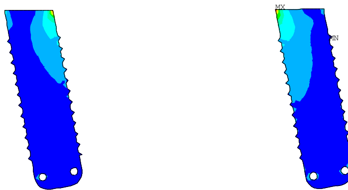
Рис. 6. Епюра еквівалентних напружень
