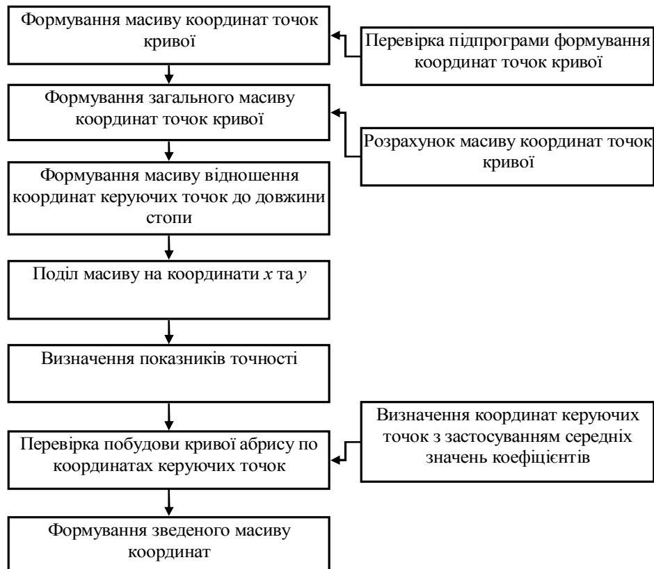
Рис. 4. Формування алгоритму автоматичного розрахунку координат кривої абрису стопи
