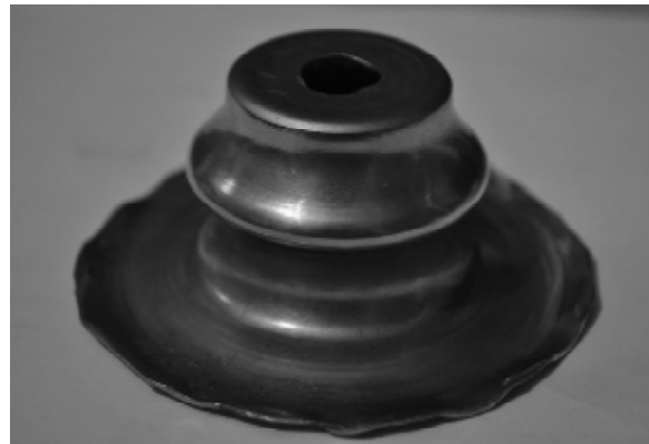
Рис. 3. Деталь опукло-вигнутої форми з листової заготовки із сталі 10 та алюмінію АД1
