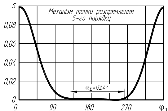
Рис. 4. Діаграма переміщень вихідної ланки, отримана у системі SOLIDWORKS Motion (а) та з використанням розробленого програмного забезпечення (б)
