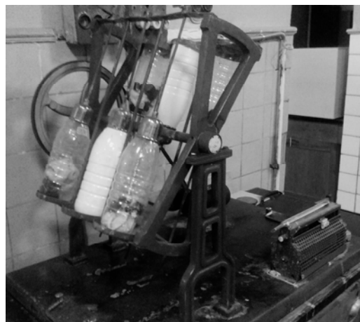
Рис. 1. Установка для проведення технологічної обробки шкіряного напівфабрикату в динаміці
