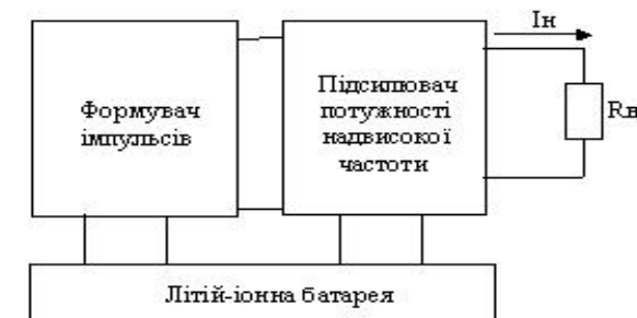
Рис. 1. Типова структурна схема генератора зонduючих імпульсів надширокосмугових мобільних радіолокаторів
