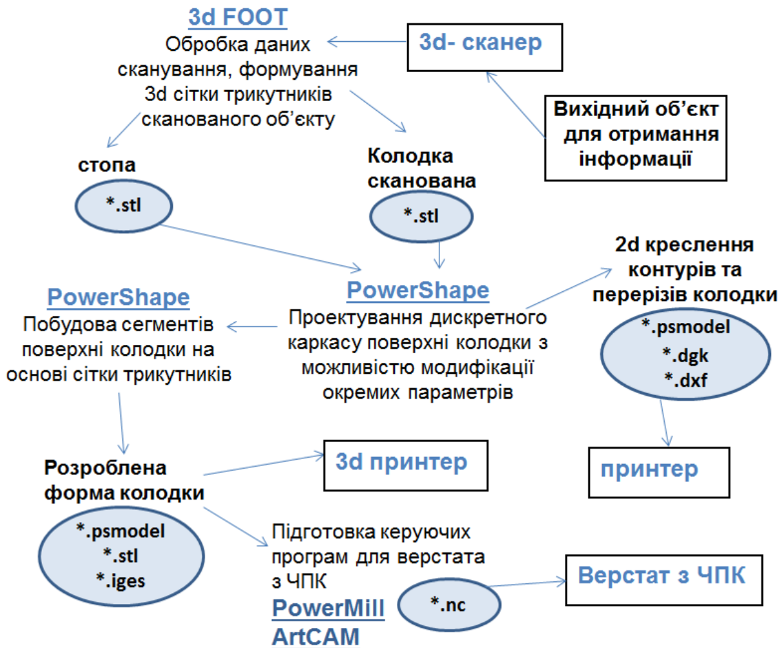
Рис. 2. Алгоритм процесу проектування та виготовлення форми колодки з використанням сучасних універсальних САПР та високотехнологічного обладнання
