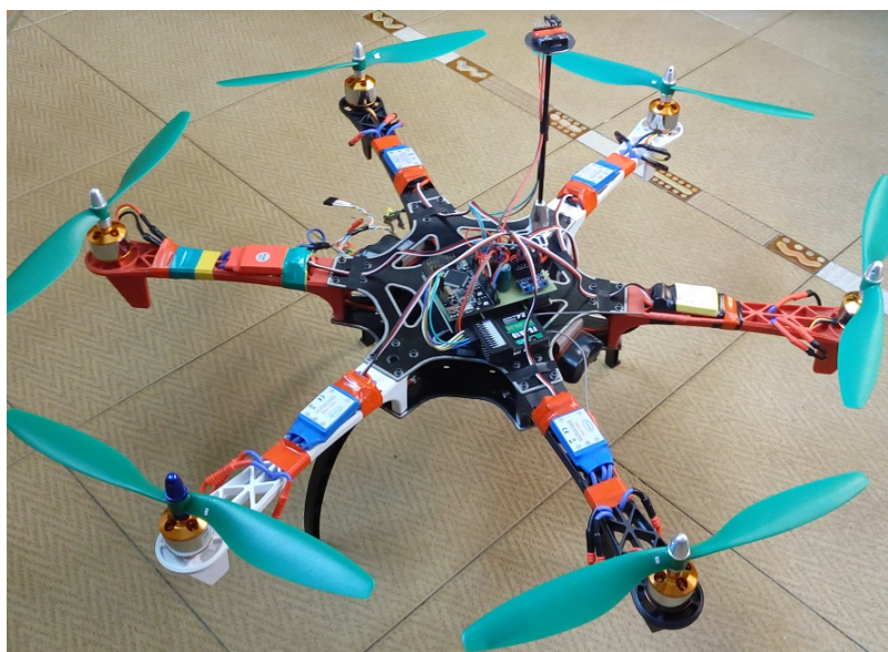
Рис.13. Фото спроектированного гексакоптера на базе Arduino mega2560
