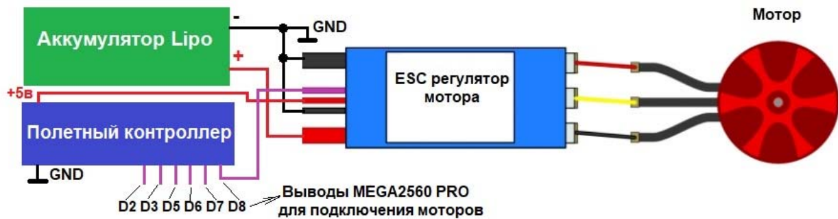
Рис. 5. Подключение шестого мотора к полетному контроллеру
