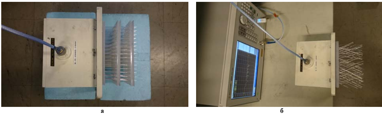
Рис. 9. Експериментальні установки для дослідження випромінювання ЕМ коливань структурами із паралельним (а) та із невпорядкованим розміщених (б) провідників
