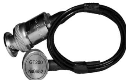
Рис. 11. Преобразователь акустической эмиссии типа GT200, работающий в диапазоне частот (50-250) кГц
