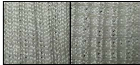
Рис. 2. Лицьова та виворітна сторона трикотажу (одинарне футероване переплетення на базі гладі)
