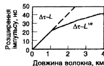
Рис. 1. Залежність розширення імпульсу від довжини багатомодового оптичного волокна[1]
