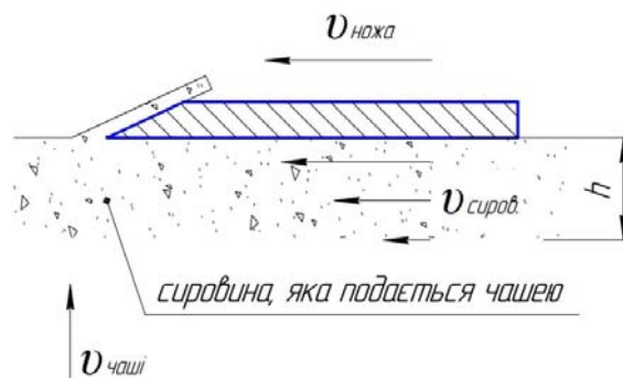
Рис. 3. Схема руху ножа та сировини при кутеруванні: v_{\text{ножа}} – швидкість руху ножа при подрібненні сировини; v_{\text{чаші}} – швидкість руху чаші пв ході її обертання; v_{\text{сиров.}} – швидкість руху сировини внаслідок її адгезійної взаємодії з ножом; h – товщина шару сировини, який рухається зі швидкістю v_{\text{сиров.}}
