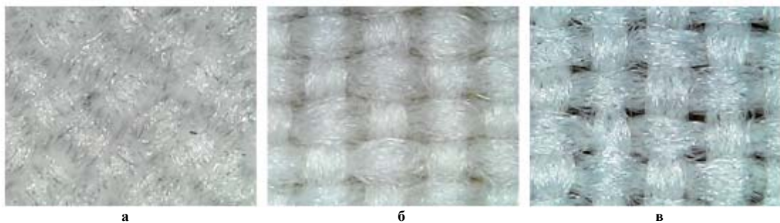
Рис. 5. Рельсфне зображення поверхні полієфірної тканини
