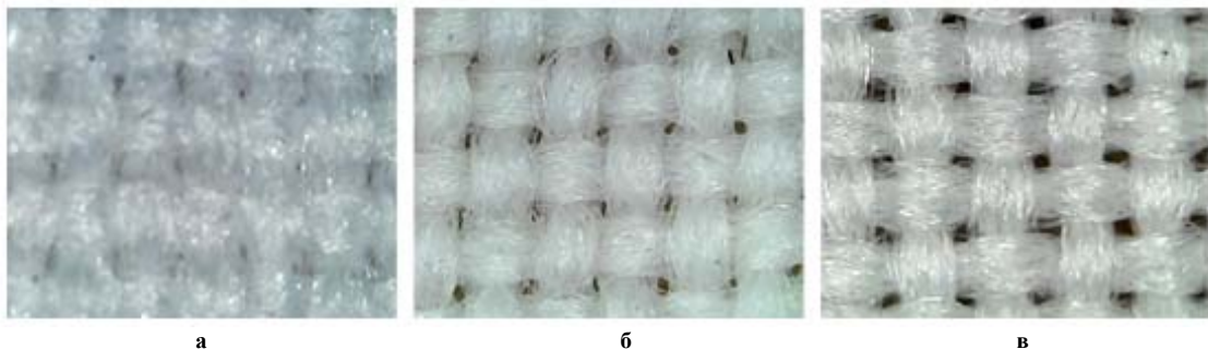
Рис. 4. Рельсфне зображення поверхні тканини, яка містить 65% бавовни та 35% полієфіру
