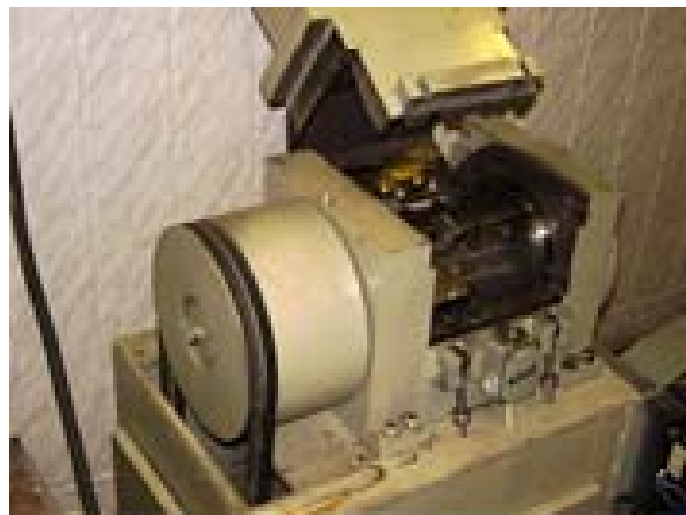
Рис. 1. Роторна ножова дробарка: а - кінематична схема; б - зовнішній вигляд установки; 1 - електродвигун; 2 - клинові паси; 3 - шків; 4 - маховик з шківом; 5 - камера подрібнення; 6 – ротор; 7 – ножі ротора; 8 – нерухомі ножі; 9 – калібрована сітка; 10 – вікно завантаження; 11 – лоток
