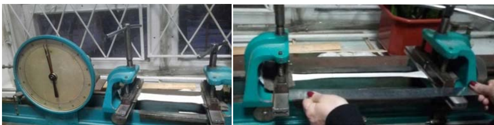
Рис. 2. Дослідження розривальних характеристик трикотажу
