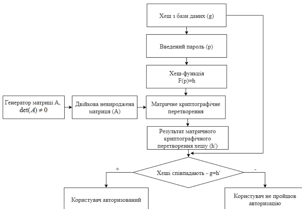
Рис. 4. Ускладнений алгоритм авторизації користувача за рахунок здійснення матричного криптографічного перетворення хешу
