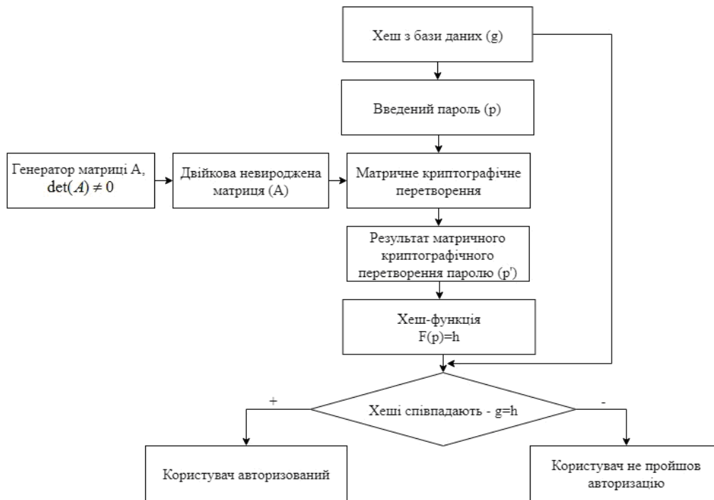
Рис. 3. Ускладнений алгоритм авторизації користувача за рахунок здійснення матричного криптографічного перетворення паролю
