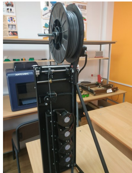
Рису. 4. Системи охолодження та намотування полімерної нитки
