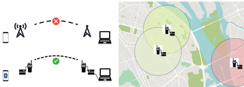
Рис. 1. Приклад використання APRS в умовах відсутності глобального зв'язку. Комунікація трьох APRS станцій у місті, коли внаслідок щільної забудови та низької потужності антени передавача одна з рацій не може встановити зв'язок з іншими клієнтами
