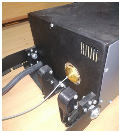
Рис. 6. Видавлювання розплавленого нейлону через фільтру екструзійної машини
