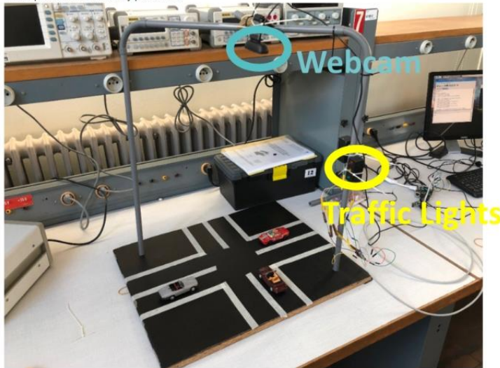
Рис. 2. Аналог системи розумного світлофора [3]
