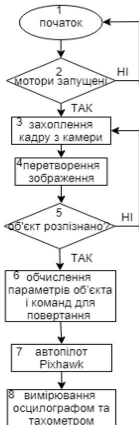
Рис. 2. Блок-схема алгоритму фотозахоплення і переслідування об'єкта 1 – початок програми, 2 – команда пуску моторів, 3 – отримання з відеокамери кадру, 4 – перетворення зображення і проведення ряду операцій з ним, 5 – перевірка чи об'єкт розпізнано на поточному кадрі, 6 – обчислення параметрів об'єкта та команд для повертання, 7 – подання команд автопілоту Pixhawk, 8 – подання інформації на осцилограф і тахометр
