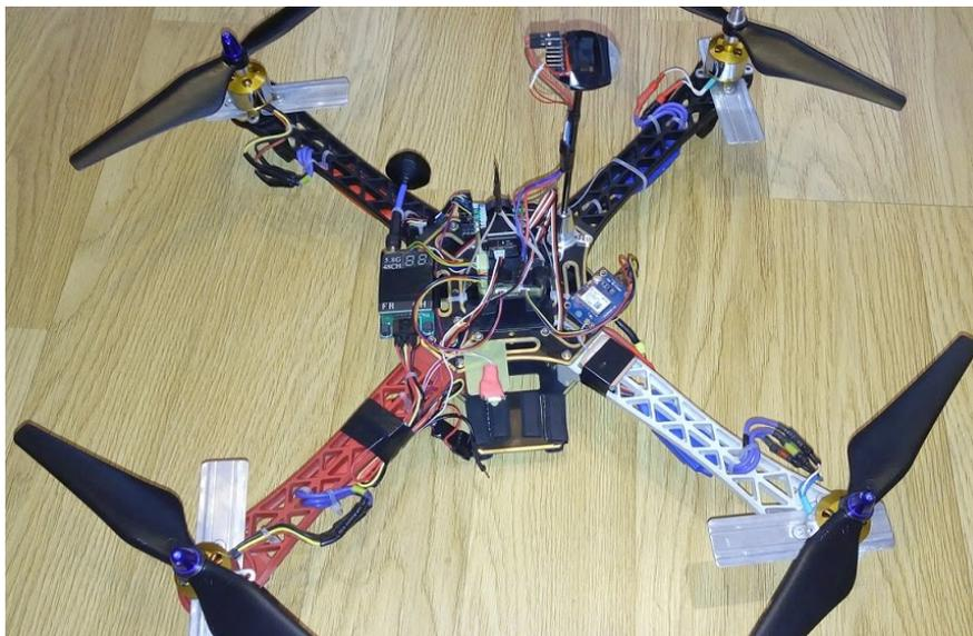
Рис. 12. Фото квадрокоптера на контроллере cc3d
