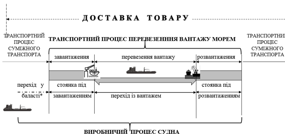
Рис. 1. Виробничий процес судна у транспортному процесі перевезення вантажів як елемент процесу доставки товару
