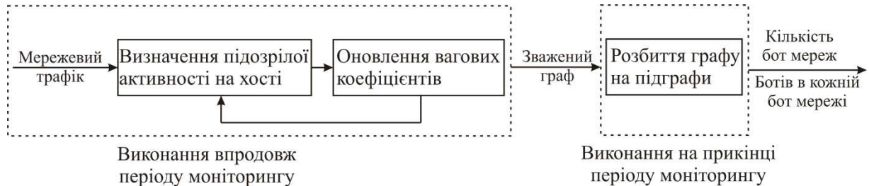
Рис. 1. Узагальнена схема методу виокремлення фрагментів бот-мереж на основі аналізу мережевого трафіку
