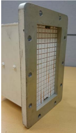
Рис. 6. Металічна сітка із періодом розміщення провідників 10 мм вмонтована у вхідний хвилевід, щоб забезпечити затухання ЕМ хвиль
