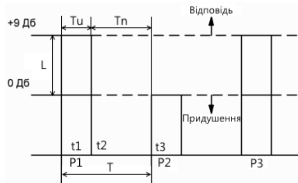
Рис. 1. Принцип передачі триімпульсного сигналу
