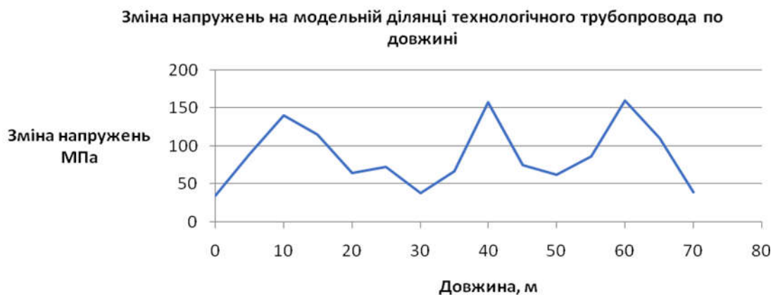
Рис. 2. Зміна напружень по перерізах модельної ділянки трубопроводу
