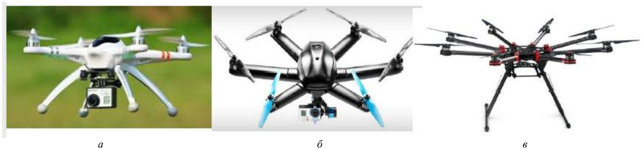
Рис. 1. Загальний вигляд конструкцій БПЛА типу «коптер»: а – квадрокоптер; б – гексокоптер; в – октокоптер
