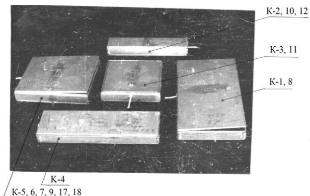
Рис. 1. Типи гермовузлів мікроскладань
