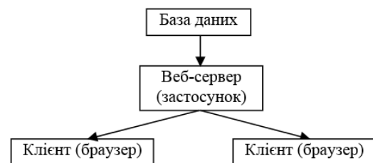
Рис. 1. Схема роботи архітектури клієнт-сервер
