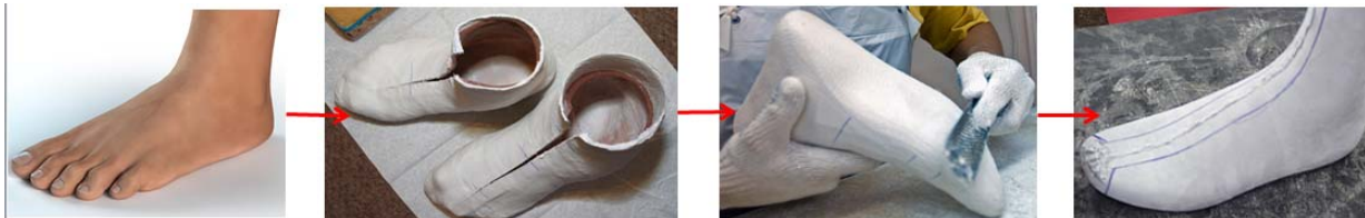
Рис. 1. Виготовлення колодки за допомогою гіпсування стопи
