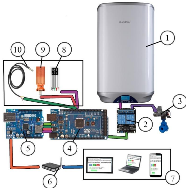
Рис. 1. Схематичне зображення елементів системи дистанційного керування бойлером: 1 – бойлер; 2 – подвійне силове реле; 3 – електричний кран; 4 – мікроконтролер ArduinoMega; 5 – EthernetShield; 6 – роутер; 7 – прилади керування; 8 – датчик температури повітря; 9 – датчик вологоти; 10 – датчик температури води в баку
