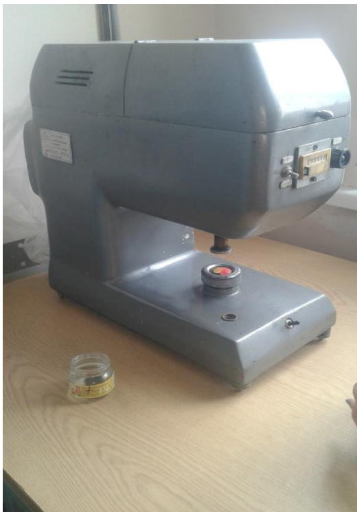
Рис. 6. Випробування зразків на мокре і сухе тертя, 100-300 обертів
