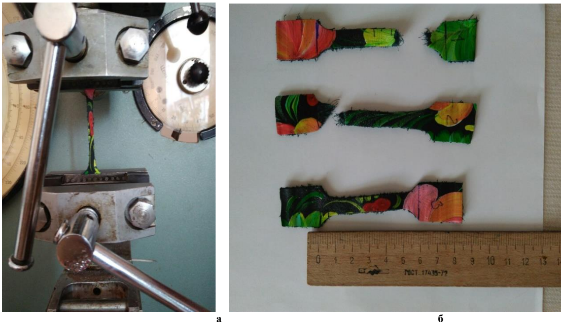
Рис. 3. Випробування зразків на розтяг, розривна машина РТ-250: а – візуалізація досліджуваного об'єкта; б – оцінка результатів дослідження
