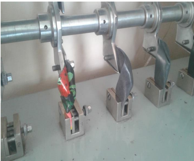
Рис. 4. Випробування зразків на стійкість до багаторазового згинання, прилад ІПК-2
