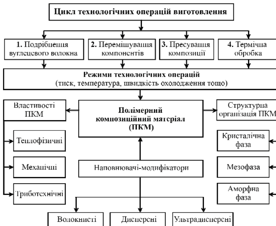
Рис. 1. Структурно-технологічна модель процесу формування складу, структури і властивостей полімерного композиційного матеріалу «графелон»
