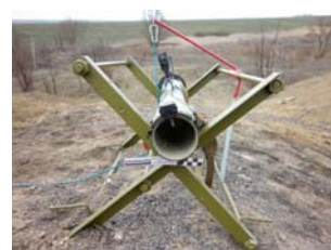
Рис. 4. Світлина пристрою для дистанційного приведення в дію реактивних гранатометів (вид по осі пострілу)
