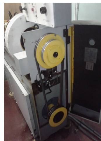
Рис. 3. Зовнішній вигляд реміної передачі установки УМТ 2168
