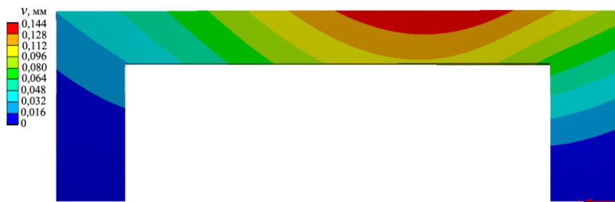
Рис. 4. Розподіл прогинів v в клині при дії навантаження P = 14 Н
