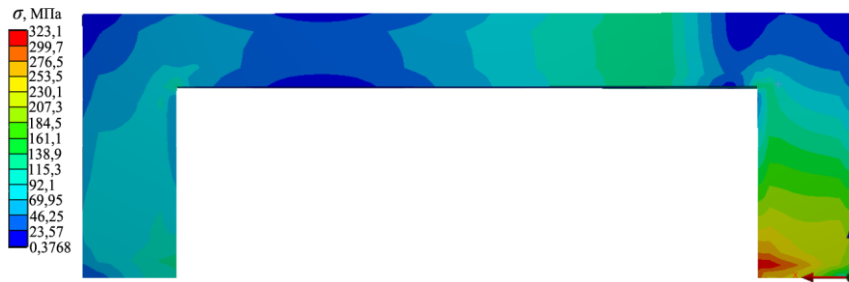
Рис. 3. Розподіл еквівалентних напружень \sigma за Мізесом в клині при дії навантаження P = 14 Н
