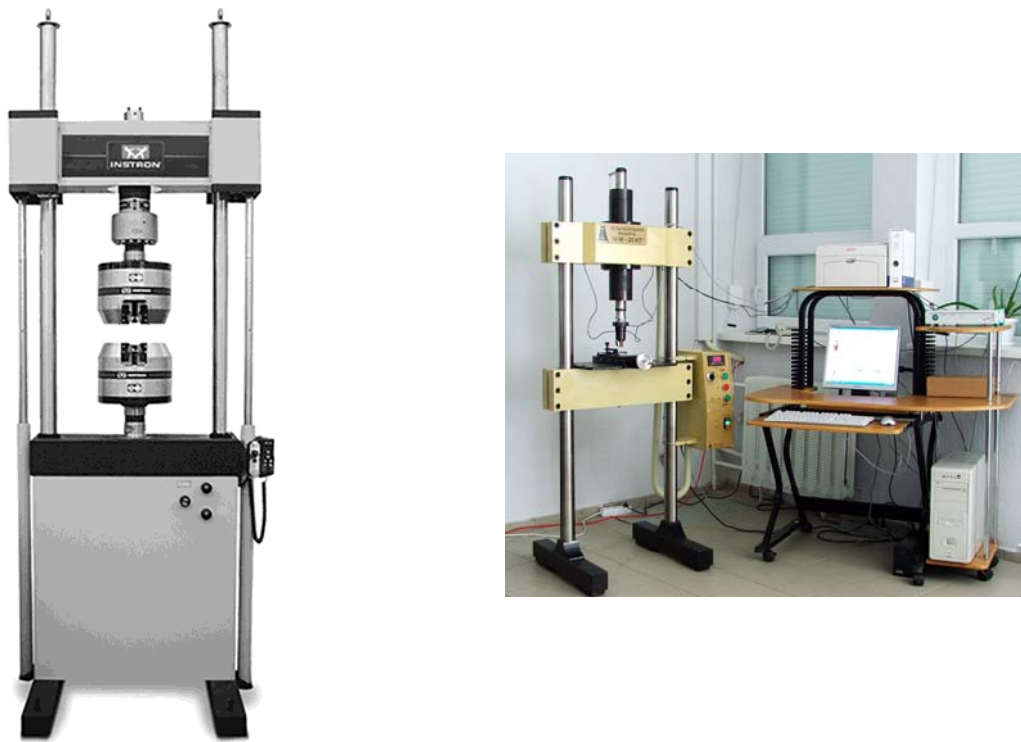
а) б) Рис. 2. Випробувальне обладнання: а) Instron 8802, б) UTM-20HT
