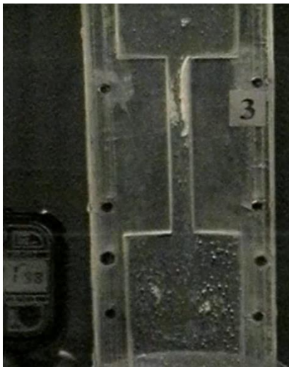
Рис. 7. Фотографія прозорого каналу з рідиною, що коливається в момент втягування рідини у камеру пульсації: виникнення кавітаційної каверни та кавітаційних пухирців при частоті коливань 5 Гц
