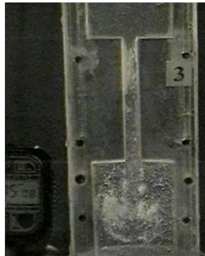
Рис. 8. Фотографія прозорого каналу з рідиною, що коливається в момент втягування рідини у камеру пульсації: виникнення кавітаційної каверни та кавітаційних пухирців при збільшенні частоти коливань до 10 Гц
