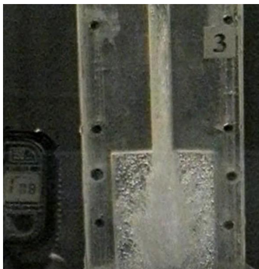
Рис. 9. Фотографія прозорого каналу з рідиною, що коливається в момент втягування рідини у камеру пульсації: виникнення кавітаційної каверни та кавітаційних пухирців при збільшенні частоти коливань до 14 Гц
