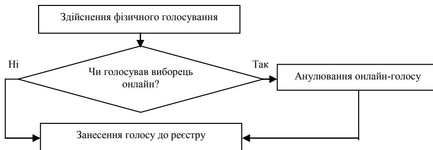
Рис. 3. Принцип роботи смарт-контракту щодо анулювання голосу
