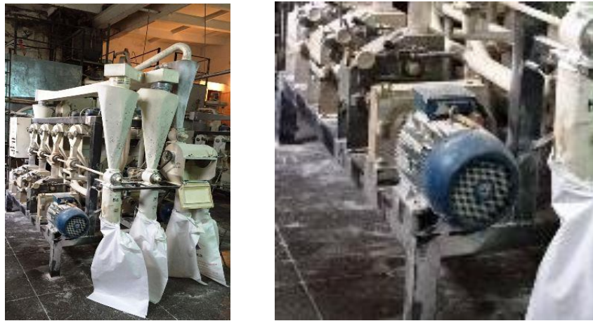
Рис. 3. Пил на електродвигуні мукомольного підприємства
