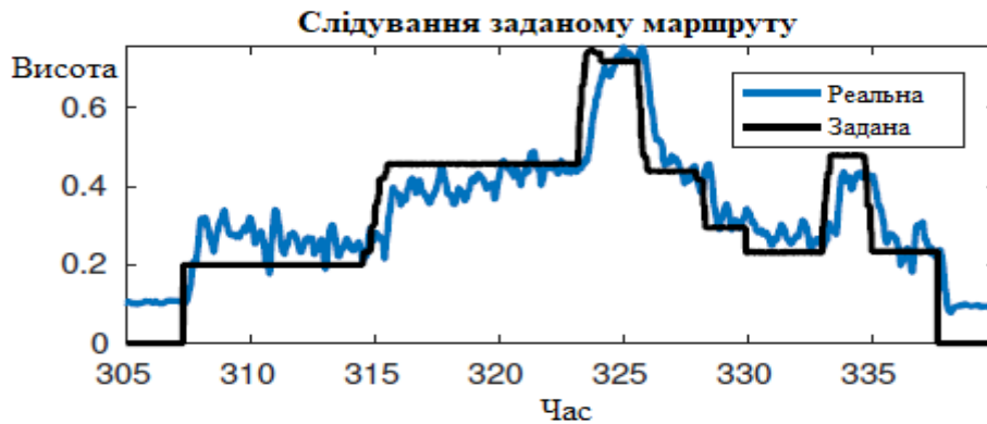
Рис. 9 Виміряна висота при дотриманні заданої висоти за допомогою LQ регулятора
