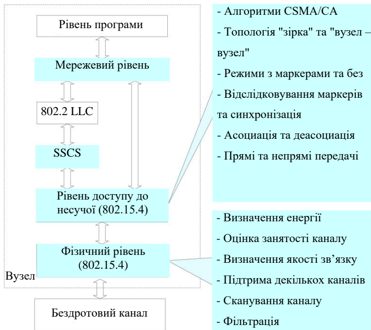
Рис. 2. Структура компонентів моделі LR-WPAN NS-2
