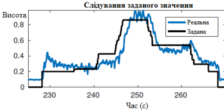
Рис. 6. Виміряна висота при дотриманні якої використовують PID-регулятор
