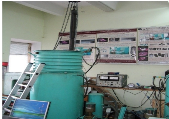
Рис. 1. Установка для вакуумного термоциклічного азотування у плазмі пульсуючого тліючого розряду
