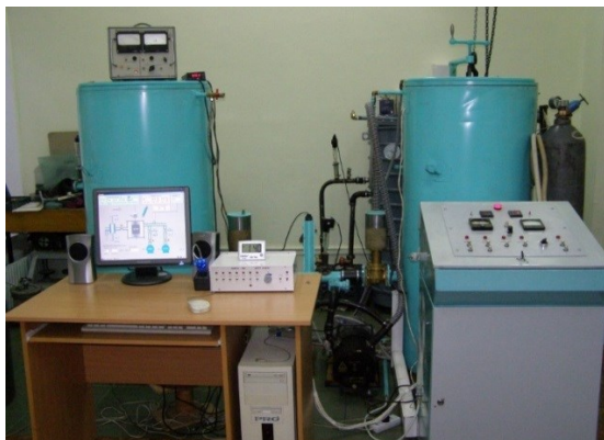
Рис. 1. Установка для вакуумного термоциклічного азотування у плазмі пульсуючого тліючого розряду
