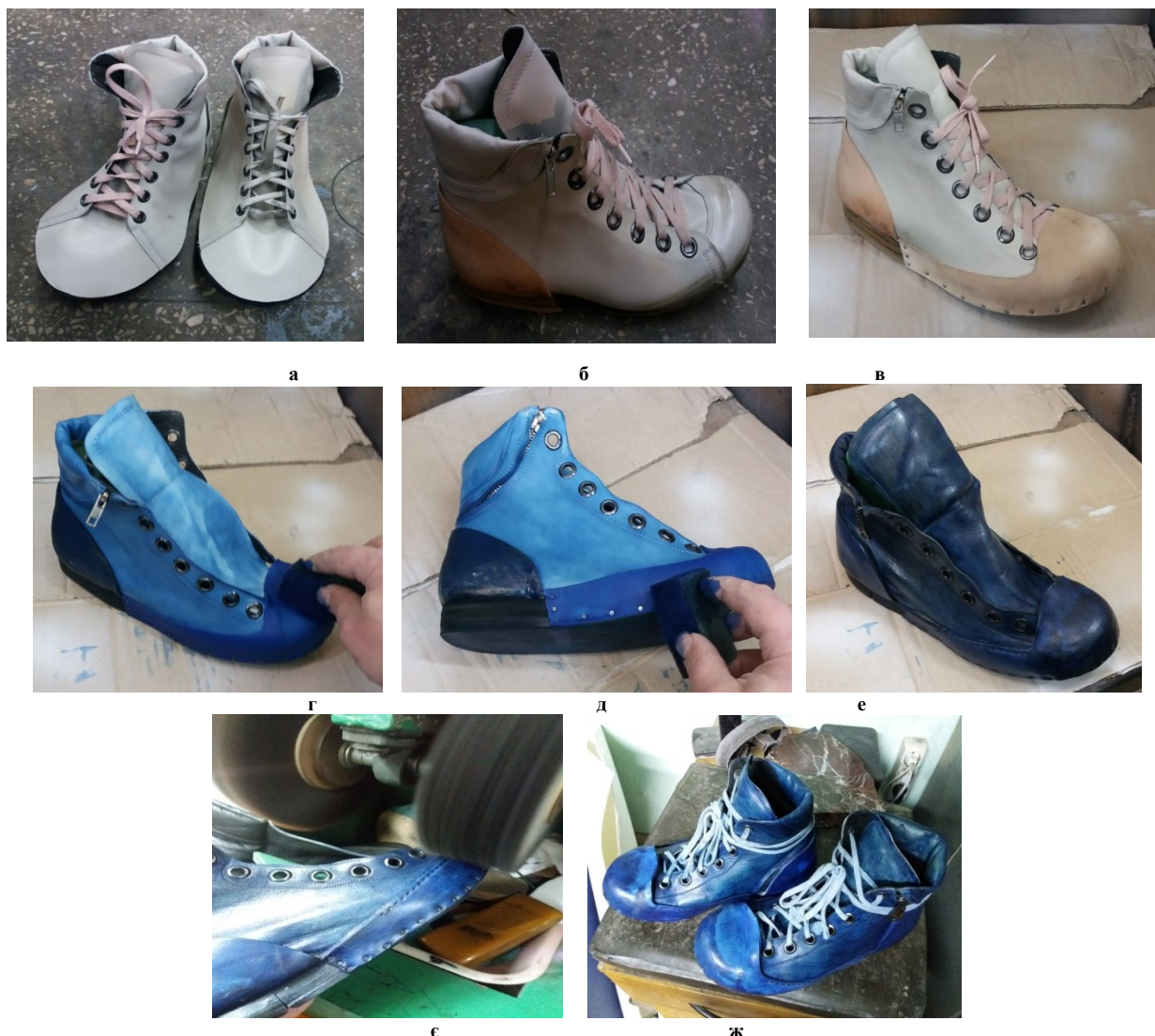
Рис.3 Візуалізація етапів технології виготовлення та фінішного оздоблення взуття за індивідуальним замовленням в стилі гранж
