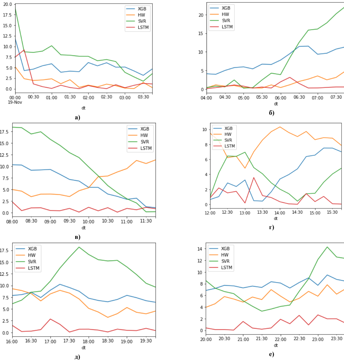
Рис. 4. Зміна похибки окремих методів адаптивної моделі прогнозування у добовому розрізі (при прогнозуванні електричного навантаження головної ділянки мережі).
