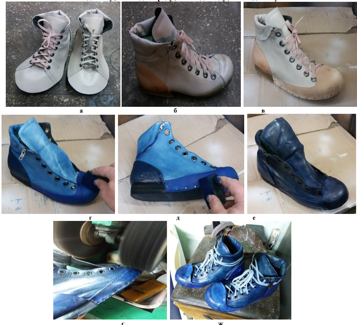
Рис. 3 Візуалізація етапів технології виготовлення та фінішного оздоблення взуття за індивідуальним замовленням в стилі гранж а – початковий етап (не оброблена заготовка з Красту); б – перший етап (зволоження, затягування заготовки на колодку, сушка); в – другий етап (знежирення заготовки мильним розчином, промивання, сушка); г, д – третій етап (нанесення фінішу б шарів, пошарова сушка); е – четвертий етап (воціння); є – п'ятий етап (полірування); ж- готове взуття.
