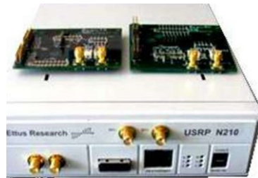
Рис. 12. Пристрій USRP з материнською та дочірніми платами
