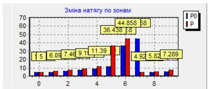
Рис.2. Діаграма зміни відносного натягу нитки на круглов'язальній двофонтурній машині для ластичних переплетень по ділянках заправки
