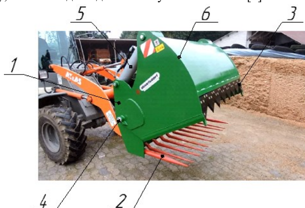
Рис.6. Вирізаючий механізм «алігаторного» – відкусуючого типу: 1-рама, 2-вила, 3-ніж, 4-вісь, 5-гідроциліндр, 6-П – подібна рамка
