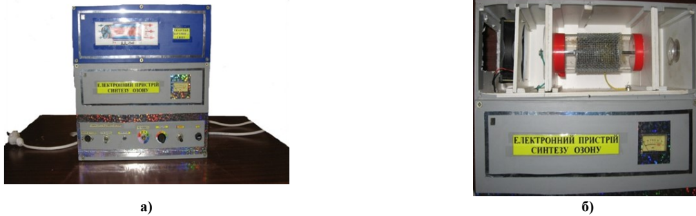
Рис. 2 Електронний пристрій синтезу озону: а) – загальний вигляд; б) – робоча камера синтезу озону
