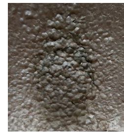
Рис. 15. Фотографія поверхні зразка з модельним забрудненням після оброблення пульсуючим струменем рідини металевими кульками, кут 125°
