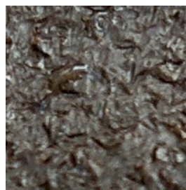
Рис. 13. Фотографія поверхні зразка з модельним забрудненням після оброблення пульсуючим струменем рідини з твердими частинками (ПС), кут 90°
