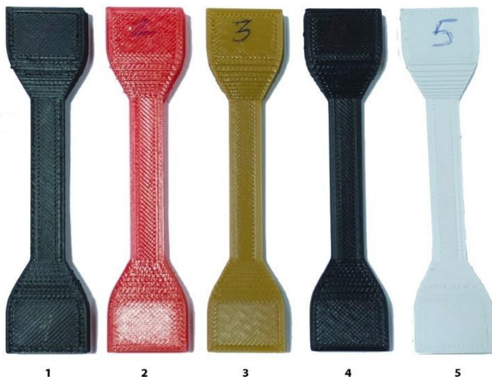
Рис. 6. Надруковані досліджувані зразки з різних видів пластику: 1 – Elastan D70; 2 – PETg; 3 – PLA; 4 – ABS; 5 – PCTG
