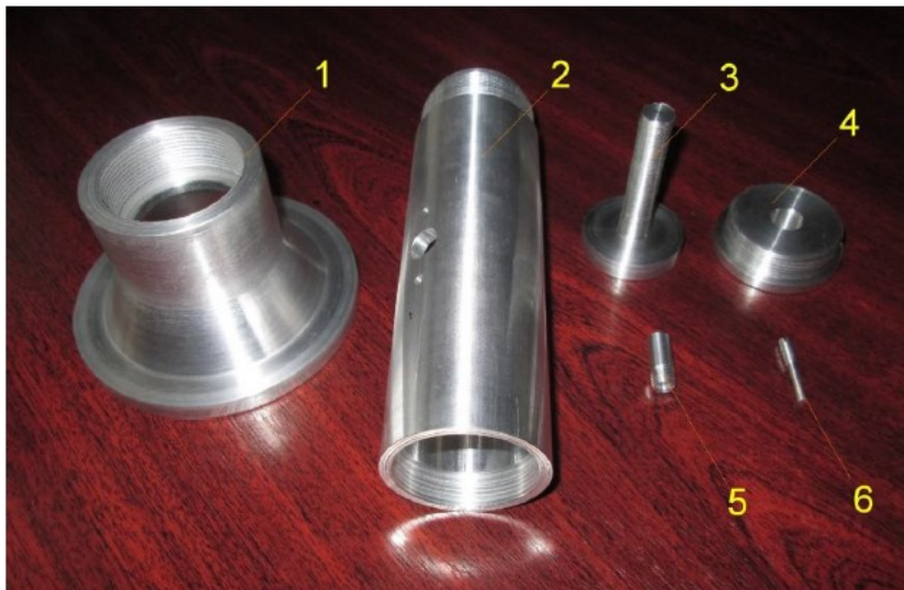
Рис. 2. Конструктивні елементи полотна рупорної антени
