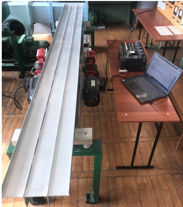
Рис. 3. Загальний вигляд вібрототка із вимірювальним обладнанням
