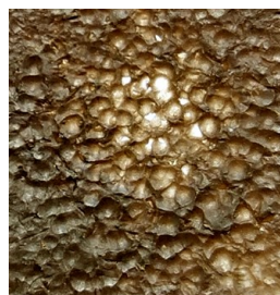
Рис. 14. Фотографія поверхні зразка з модельним забрудненням після оброблення пульсуючим струменем рідини металевими кульками, кут 90°
