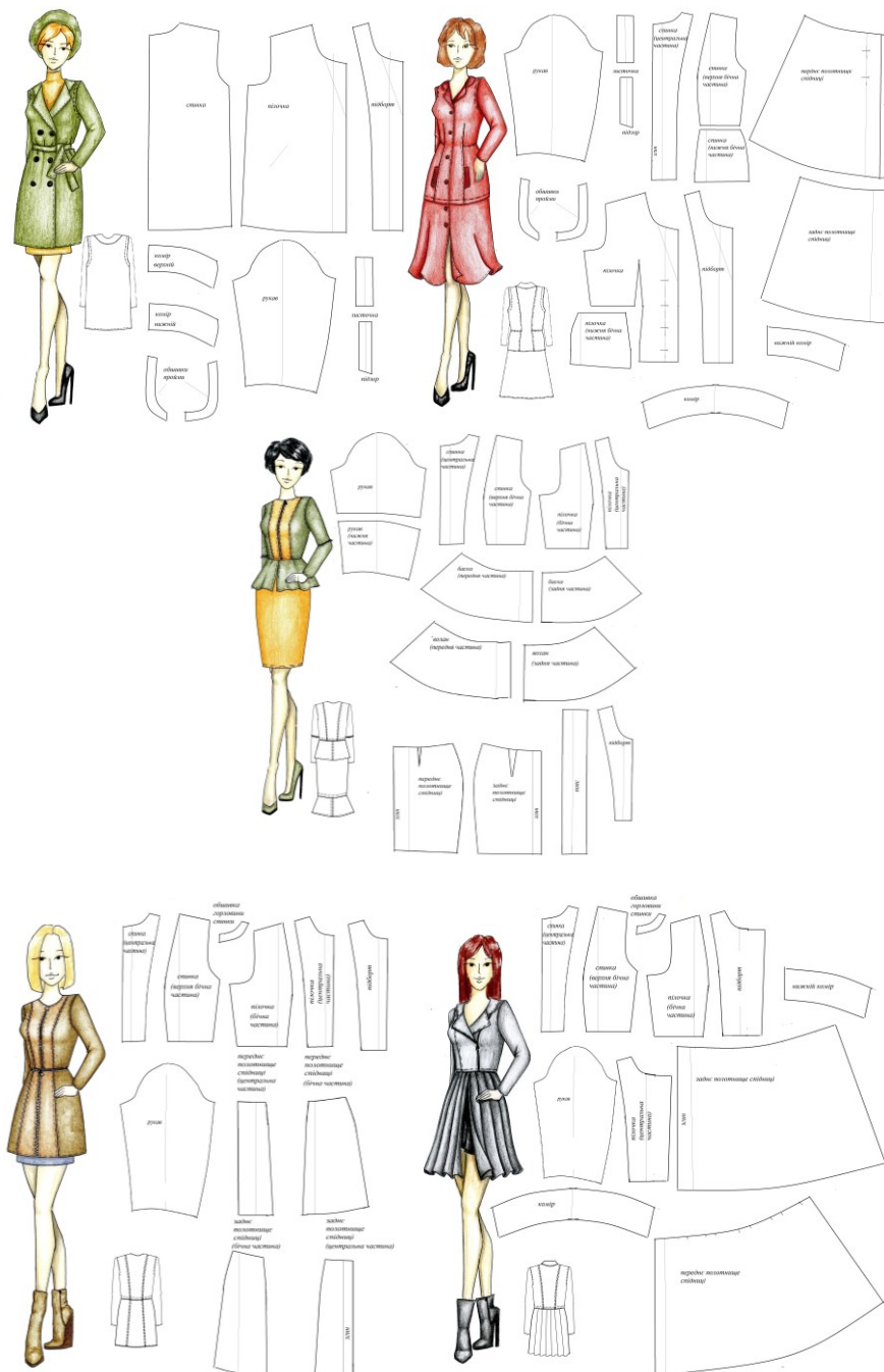
Рис. 4. Деталі крою виробів колекції верхнього одягу зі штучної шкіри (основний матеріал)
