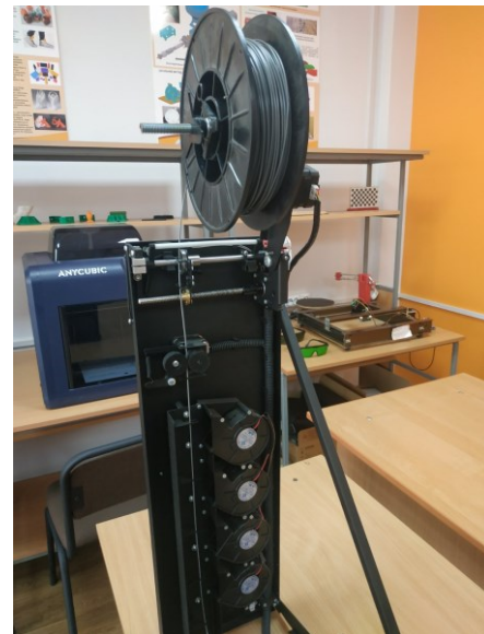
Рису. 4. Системи охолодження та намотування полімерної нитки
