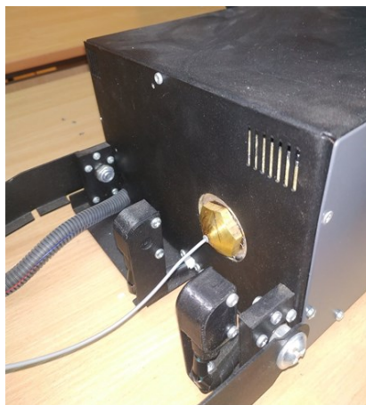
Рис. 6. Видавлювання розплавленого нейлону через фільтру екструзійної машини
