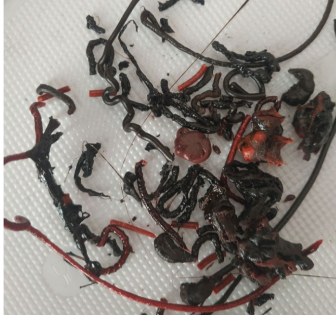
Рис. 5. Дефекти нагріву полімерів
