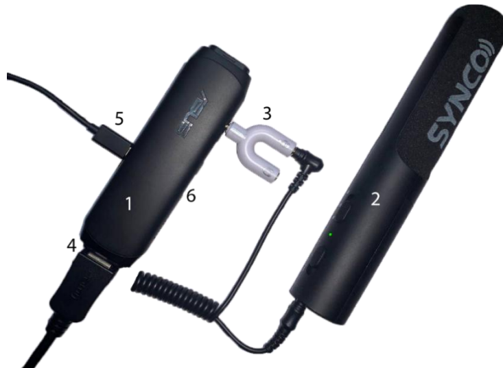
Рис. 1. Фотографія комплексу «Комп'ютер-мікрофон»: 1 – комп'ютер ASUSTS-10, 2 – мікрофон SyncoMic-M3, 3 – розгалужувач лінійного входу, 4 – вихід HDMI, 5 – вхід живлення Micro-USB, 6 – 2 USB входи
