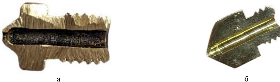
Рис. 3. Сопло в розрізі: а – з циліндричним та конічним каналом; б – з додатковим циліндричним каналом
