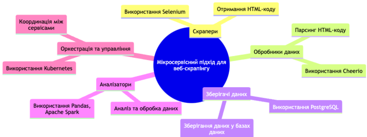
Рис.1. Архітектура системи для реалізації мікросервісного підходу в процесі веб-скрапінгу великих обсягів даних з веб-сайтів із динамічним вмістом
