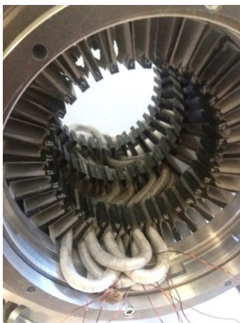
Рис.5. Укладка обмотки якоря МПСБР
