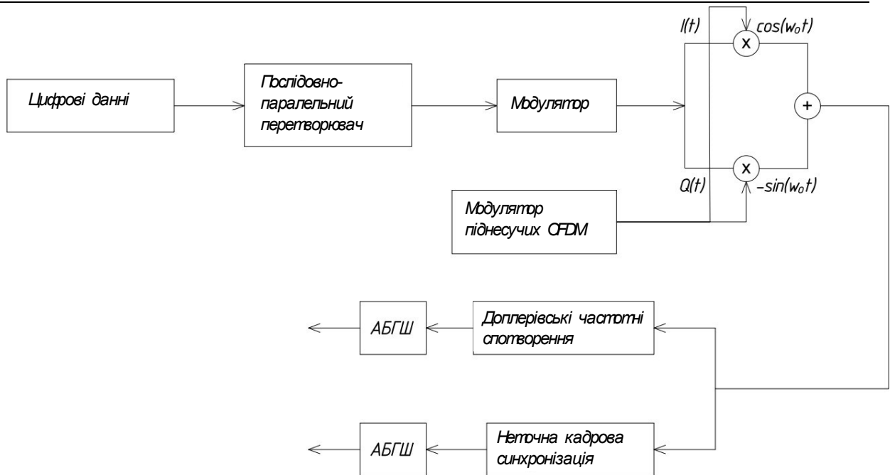
Рисунок 2 – Структура моделі для модуляції сигналу
